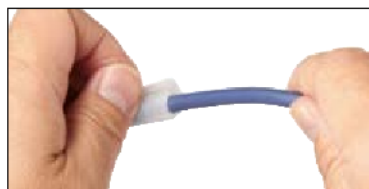
ケーブルの規定位置にテープを巻く
